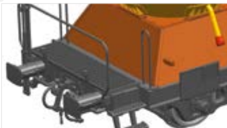
Plataforma de maniobras detallada con rejilla abierta
