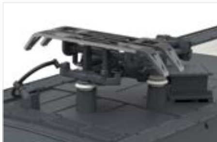
Pantógrafo de diseño nuevo con fijación invisible
