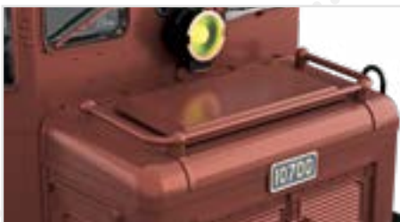
Asideros independientes y cubierta aplicada por separado a la parte delantera
