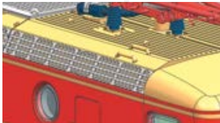
Asideros separados y rejillas de ventilación fieles al original en el techo en pendiente
