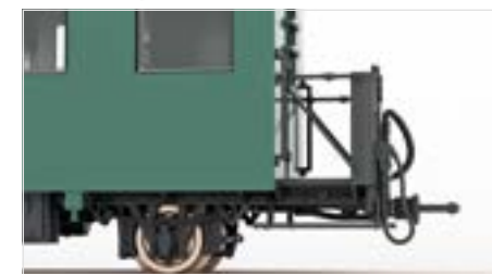
Zona de la plataforma con fijación de acoplamiento casi invisible
