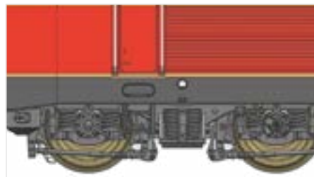
Bogies y cubierta de la caja de grasa con grabado detallado
