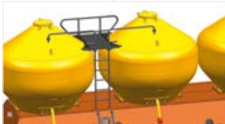
Pasamanos y escalones de entrada independientes
